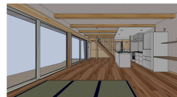
6月22日12時(前日が夏至) 大きな開口の上にある庇で日射を遮っている様子がわかります
